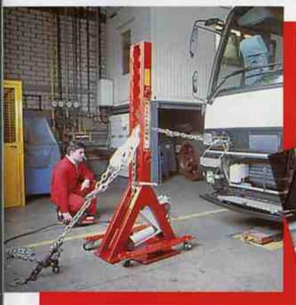
↓ Die Verankerung des Turmes erfolgt durch 2 Bodenanker. Dadurch Verstärkung der Verankerung bei hohen Zugkräften. Somit auch Veränderung der Zugrichtung leicht möglich.
