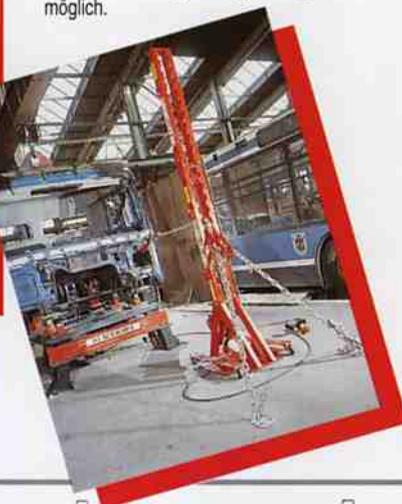
**Maxi Tower 15 - 30 t** Zugturm für Autobusse. Volle 30 t Leistung im Dachbereich von Doppeldeckerbussen.
