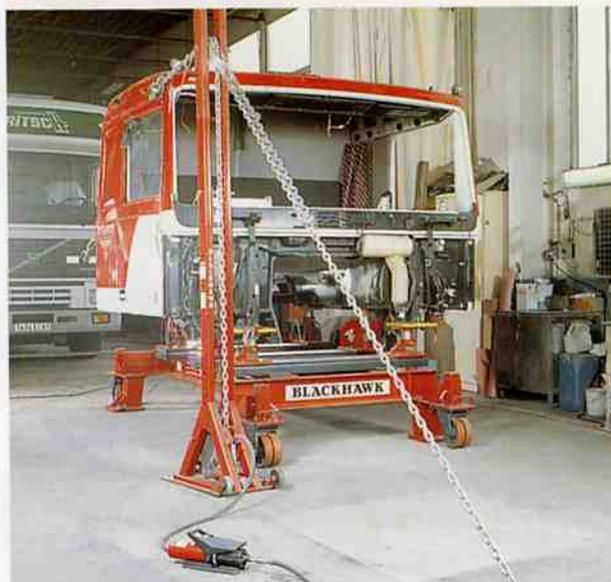
Mit dem **Power Post** Zugturm können Sie mit einer oder mehreren Verlängerungen Züge in Dachhöhe ausführen, mit **der gleichen Zugleistung**, falls erforderlich, wie bei den Zügen im Bodenbereich.
