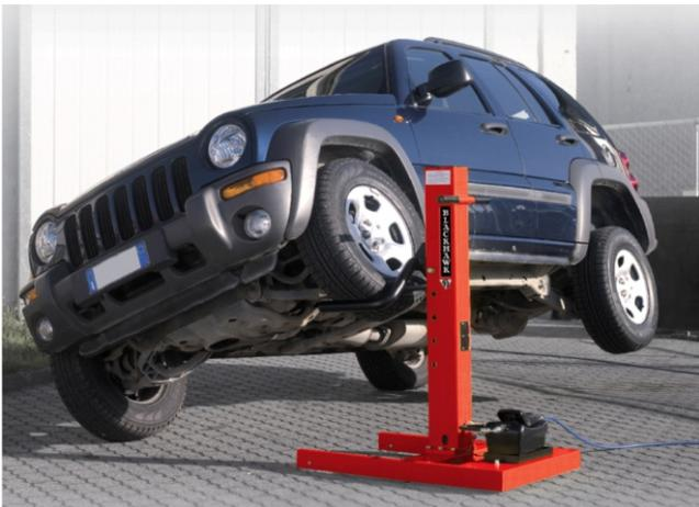
STL16 ist ein mobiler und stabiler Einsäulen-Heber. Für Arbeiten an der Karosserie sowie am Unterboden und an den Räder, drinnen wie draußen. Der Heber arbeitet mit einem Hydraulikstempel und lufthydr. Pumpe. (ohne Elektromotor), dadurch auch in Lackierereien einsetzbar.
